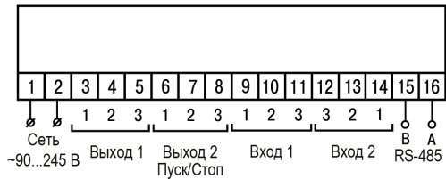
Рисунок 5.2 – Общая схема подключения ТРМ210-Н, -Щ1 и -Щ2
